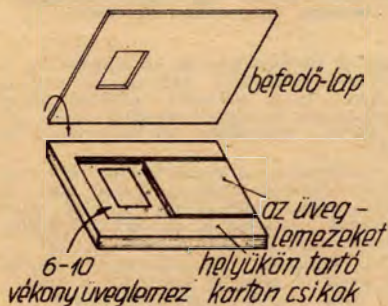
1. ábra. 6—10 mikroszkópi fedő üveglemezt tesszünk egymásra és ablakkal ellátott papírlapok közé szorítjuk
